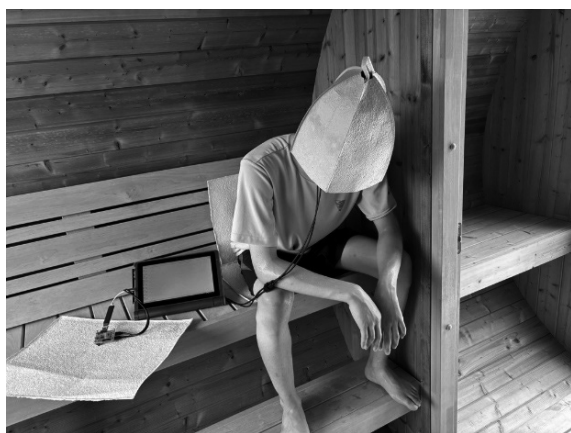
図2 サウナ室内での温度・湿度の計測
