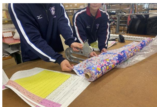
反物（巻き布）の長さを求めるため 生地の厚みを紙厚計測器で測定する様子
